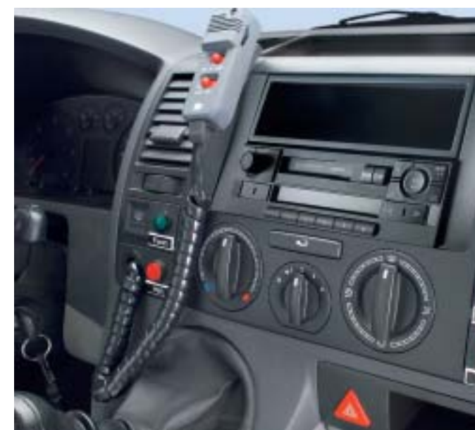
Środkowa część kokpitu z pilotem sterującym sygnalizacją świetlną-dźwiękową, dodatkową sygnalizacją pneumatyczną oraz systemem MWS pozwalającym pozostawić ambulans z pracującym silnikiem po wyjęciu kluczyka ze stacyjki.
