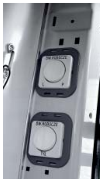
Sterowanie oświetleniem zewnętrznym z przedziału medycznego.
