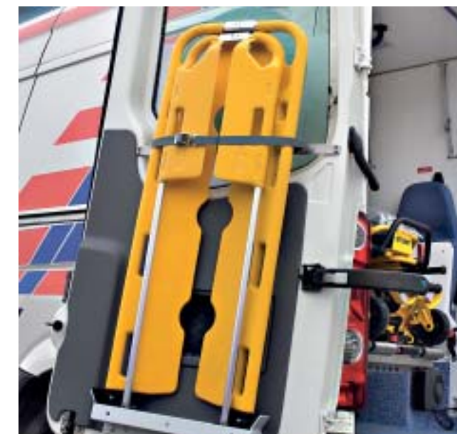
Skrzydło drzwi tylnych – miejsce mocowania noszy podbierakowych.
