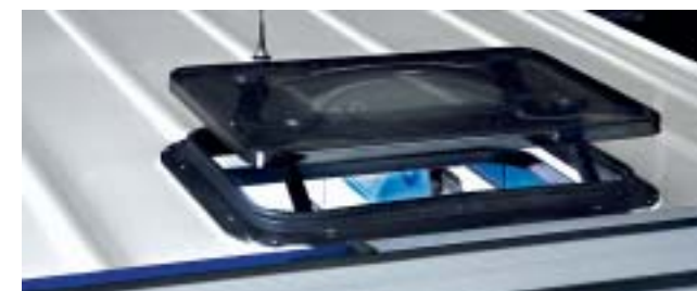
Okno dachowe jest dodatkowym źródłem światła oraz zapewnia odpowiednie przewietrzanie przedziału medycznego.
