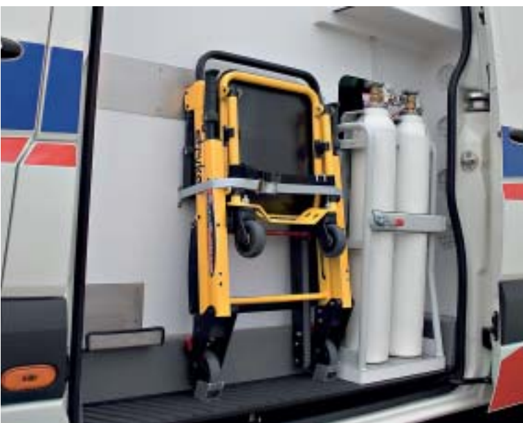
Zewnętrzny schowek na wyposażenie ortopedyczne i butle tlenowe za lewymi drzwiami przesuwными.
